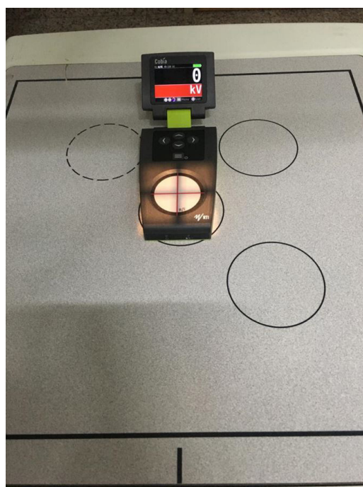
Figura 2. Detector semicondutor com campo de luz ajustado.
