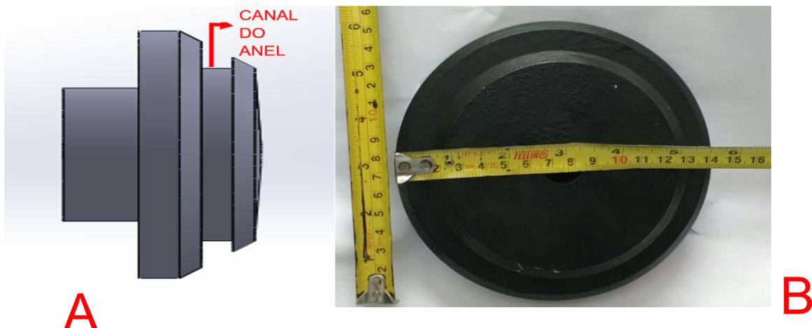
**Figura 3-** Projeto do volante do motor (A); volante construído para o motor (B).
