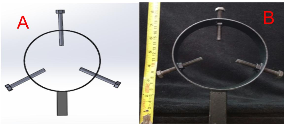
**Figura 6-** Projeto da luneta alternativa (A); luneta alternativa construída (B).
